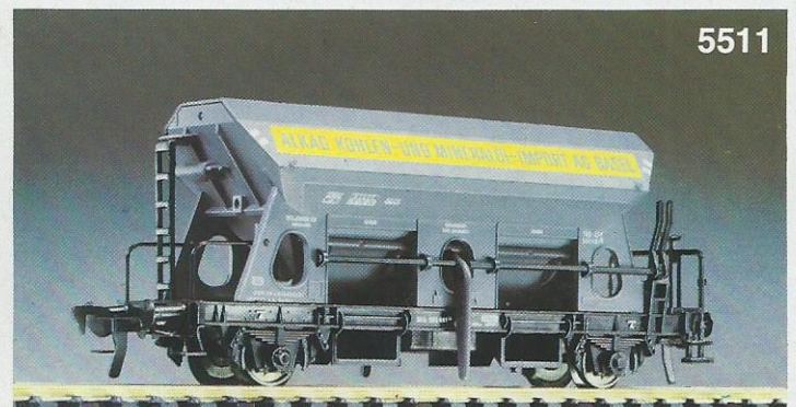
5511 · Selbstentladewagen eines Schweizer Unternehmens, LÜP: 122 mm. Mit 4 beweglichen Schieberverschlüssen am Wagenboden zur automatischen Entladung des Schüttgutes
