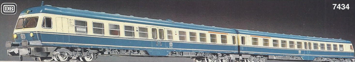
7434 · Modell des 2-teiligen Dieseltriebzuges der DB. Baureihe 614. Moderne "ozeanblau/beige" DB-Lackierung. Lüp: 334 mm. Alle technischen Einzelheiten sind wie bei 7430.
