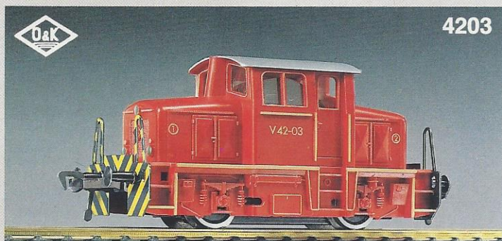
4203 · Modell der B-dieselhydraulischen Mehrzweck-Lok, Baureihe MV 9 von O & K. LÜP: 96 mm. Modell vorbildentsprechend detailliert, lackiert und beschriftet. Eingesetzte Fenster. Antrieb auf alle 4 Räder. Vom Trafo aus eindeutig fernsteuerbar für Vorwärts- und Rückwärtsfahrt. Beidseitig automatische Kupplung.
