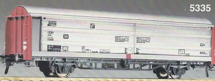
5335 · Gedeckter Schiebewandwagen, Modell des Hbis 299 der DB, LüP: 161 mm. Silber/rotbraune DB-Lackierung, vorbildentsprechend beschriftet, je Seite mit 2 beweglichen Schiebetüren.
