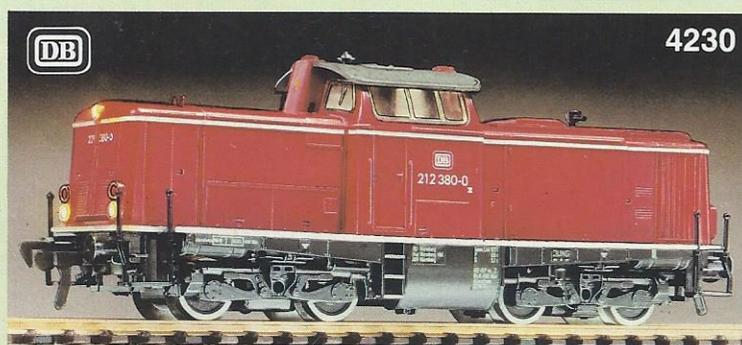
Das Original hat die Nummer 212 380-0, leistet 1350 PS, wiegt 63,5–65,5 Tonnen und fährt im Streckengang 100 km/h und im Rangiergang 65 km/h.
