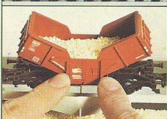
Beide Wagenkastenhälften können mittels Handhebeln zur Entladung durch den Wagenboden angehoben werden. Rotbraune DB-Lackierung mit vorbildentsprechender Beschriftung.
