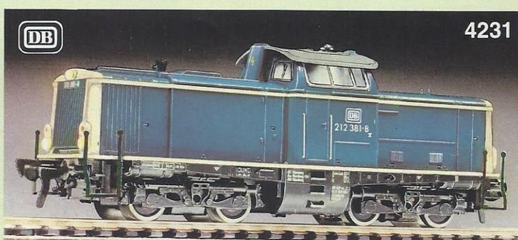
Das Original hat die Nummer 212 381-8, leistet 1350 PS, wiegt 63,5–65,5 Tonnen und fährt im Streckengang 100 km/h und im Rangiergang 65 km/h.
