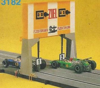
**3182** · **Rundenzähler**, 99-0 zählend, elektro-mechanisch - passend für alle Fabrikate sowie für die Baugrößen 1:24 und 1:32. In beliebiger Anzahl nebeneinander aufzustellen, d. h. verwendbar für 2, 4, 6, 8 usw. Fahrbahnen, wobei das Siegerfahrzeug den Fahrstrom für die nachfolgenden Wagen automatisch abschaltet und somit der Sieger einwandfrei feststeht.
