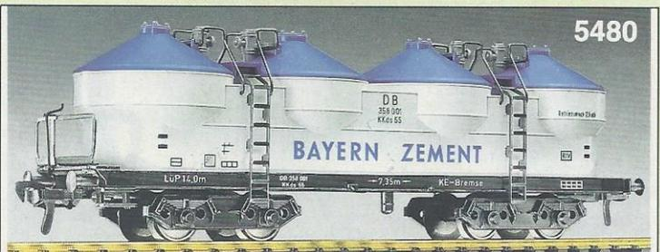
5480 · Zementtransportwagen "BAYERN ZEMENT", 4-achsig, Modell des Feinschüttgut-Transportwagens KKds 55 der DB für Druckluftentleerung, LüP: 170 mm. Vorbildliche Lackierung und Beschriftung, zahlreiche aufgesetzte und ausgespritzte Armaturen an Oberteil und Fahrgestell, vorbildgetreue Original DB-Einheits-Güterwagendrehgestelle.
