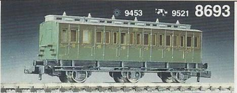
**8693** · Abteilwagen C<sup>6</sup> tf der SNCF, LÜP: 69 mm. 3-achsig, mittlere Achse seitenverschiebbar, eingesetzte Fenster, alle Einzelheiten nachgebildet, mit Innenbeleuchtungsgarnitur 9453 beleuchtbar.
