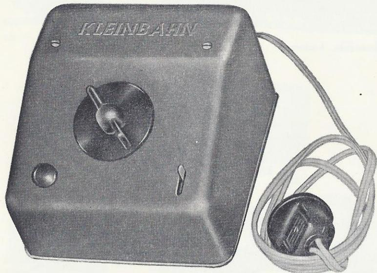
Auf der Deckplatte befindet sich der Fernschalter für Vor- und Rückwärtsfahrt. Daneben das rote Kontrolllicht. Dieses erlischt bei Kurzschluß. Der Trafo schaltet sich automatisch ab. In diesem Fall Netzstecker sofort ziehen und erst dann Kurzschluß in der Anlage beheben. Mit einem Trafo darf **nur 1 Lokomotive** betrieben werden.
