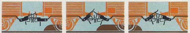
Durch Heben der Kuppelbrücke wird die Kupplung geöffnet.
