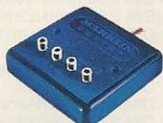
**1592** **1592 Gleichrichter** · Zum Anschluß an MÄRKLIN-Eisenbahn-Transformatoren · Abmessungen 57 x 52 x 15 mm · An den beiden mit Auto 1 und Auto 2 bezeichneten Buchsenpaaren kann Gleichstrom zum gleichzeitigen Betrieb bis zu 4 Fahrzeugen abgenommen werden · Der vorgeschaltete Transformator muß eine Leistung von mindestens 16 VA aufweisen
