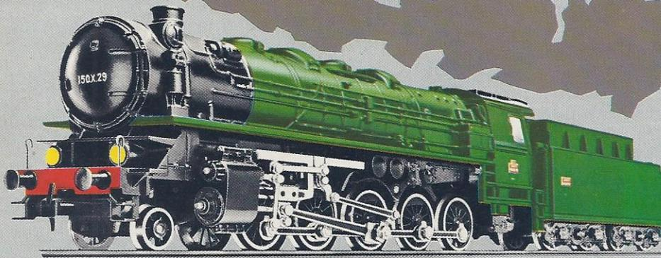
**3046 Schwere Güterzuglokomotive mit Schlepptender** · Modell der Baureihe 150 X der Société Nationale des Chemins de Fer Français (SNCF) mit der Achsfolge 1'E · Durch Unterteilung des Fahrgestells in zwei gelenkig miteinander verbundene Treibradgruppen werden trotz der 5 angetriebenen Achsen sehr gute Fahreigenschaften und Beweglichkeit in den Kurven erreicht · 4 Haftreifen · Nachbildung der Heu-
