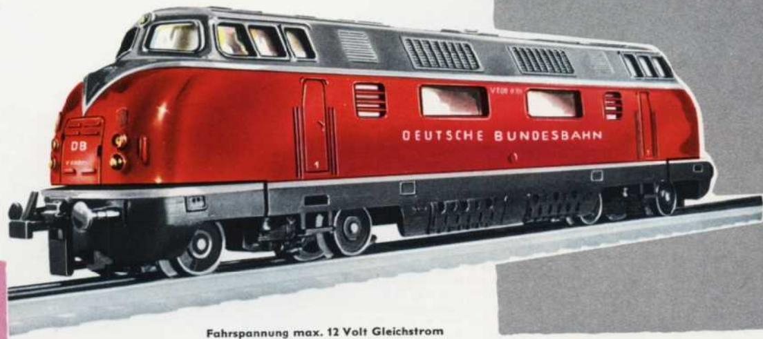
Fahrspannung max. 12 Volt Gleichstrom
