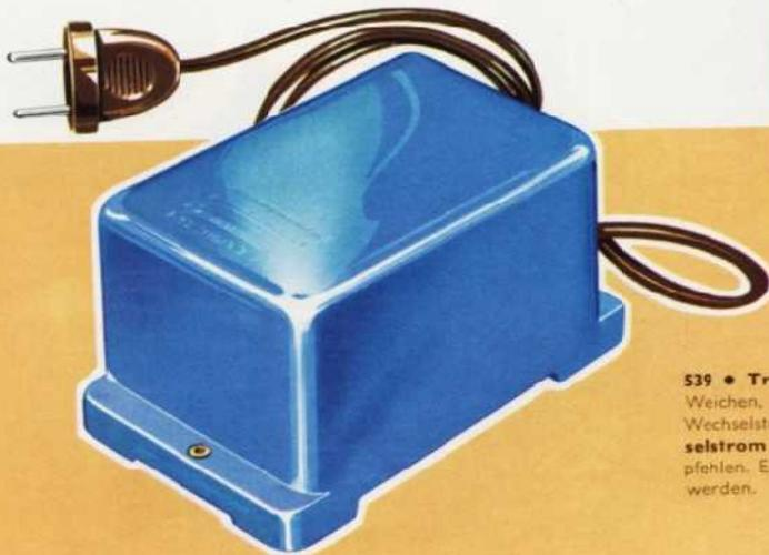
**539 • Transformator** für Beleuchtung und für den Betrieb magnetischer Artikel wie Weichen, Signale, Entkopplungsleise, Relais. Dieser Transformator kann nur an das Wechselstrom-Lichtnetz 220 Volt angeschlossen werden. Leistung 45 VA (14 Volt **Wechselstrom** ca. 3,2 Amp.). Dieser Transformator ist besonders für große Anlagen zu empfehlen. Es können bis zu 60 Lämpchen von Weichen bzw. Bogenlampen angeschlossen werden. **DM 24,50**
